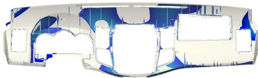
Modello originale con deformazione VS. modello originale
