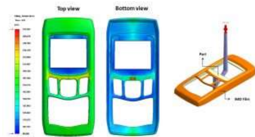
Fig.8 Il modulo In-Mold Decoration (IMD) analizza la distribuzione delle temperature sulla superficie del pezzo
