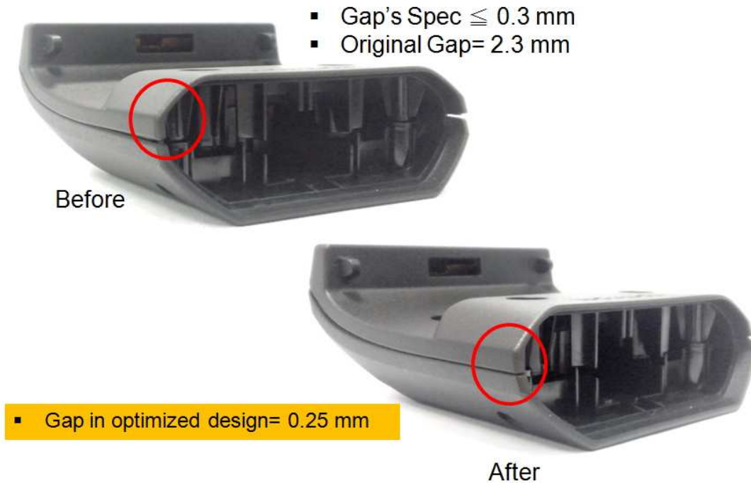
Figura. 11 La foto delle parti reali stampate con gap originale e gap ottimizzato
