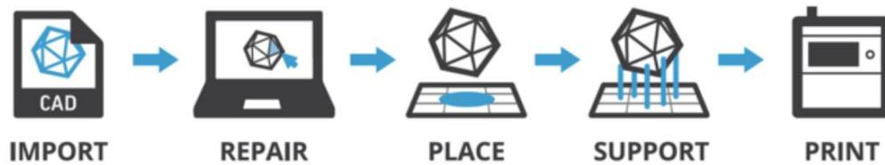
Figura 2 fasi principali di un processo di stampa 3D mediante stereolitografia
