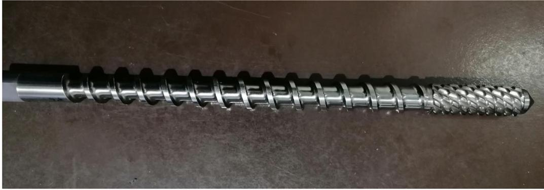
Figura 44 vite di plastificazione della pressetta Megatech H7/18.
