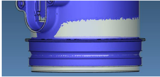
Figura 12. Molten core dopo 5s dall'inizio della fase di mantenimento
