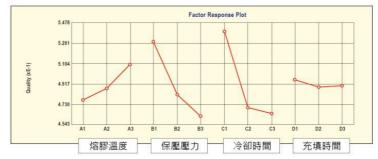
Risultati XY da Moldex3D DOE per il contenimento della deformazione e del ritiro
