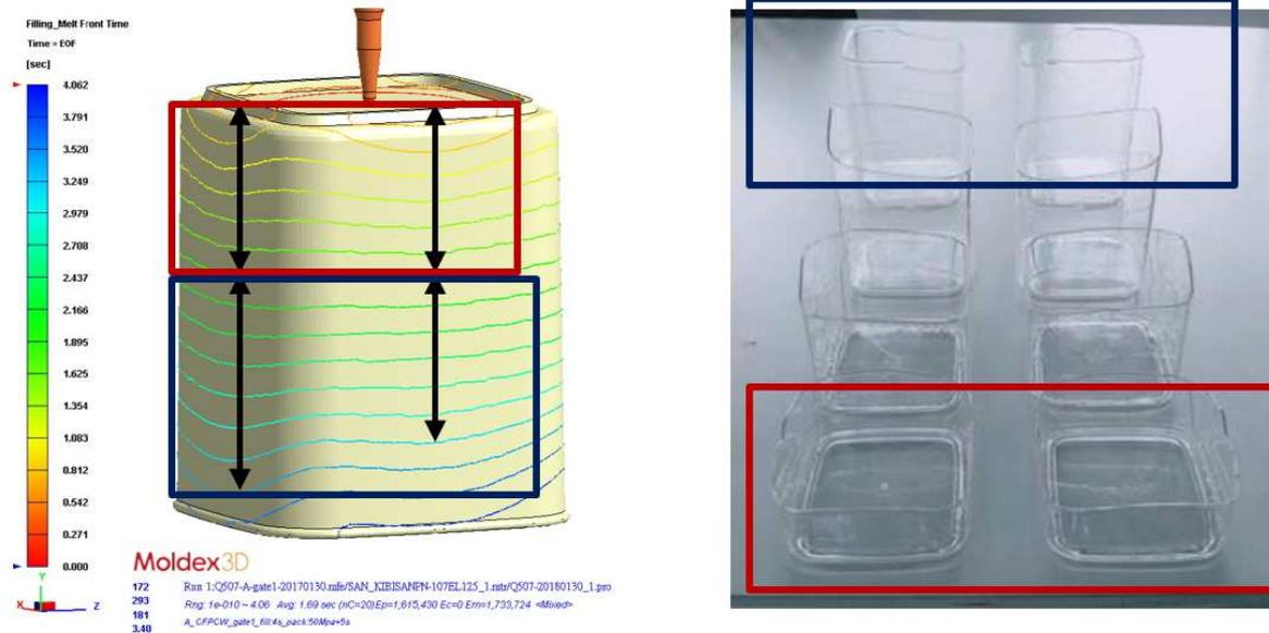
Fig. 2 Lo squilibrio di flusso indicato dai contorni frontali di fusione nella simulazione Moldex3D (a sinistra) è coerente con i risultati sperimentali (a destra).
