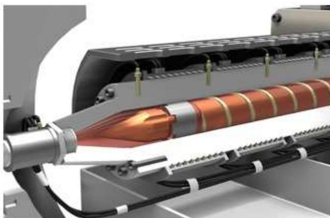
La compressione all'interno del barile della macchina di stampaggio per una simulazione più completa del barile su applicazione dell'analisi di riempimento dello stampaggio a iniezione
