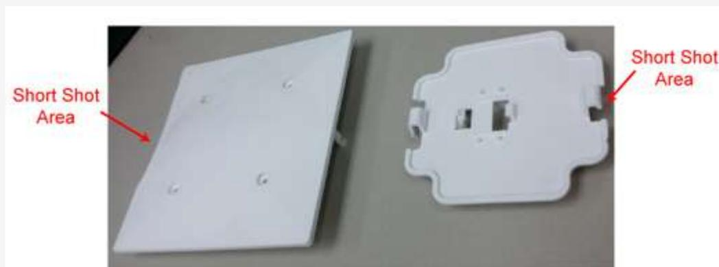
Figura. 5 L'iniezione definitiva dei pezzi stampati, come da progetto modificato, per una parte più grande (a sinistra) e una parte più piccola (a destra) hanno identiche posizioni short di colpo con il risultato della simulazione in Fig. 3.
