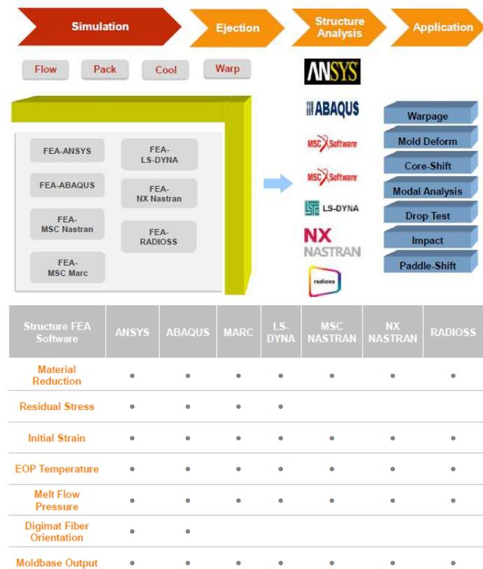
Alla fine delle attività di analisi e simulazione in Moldex3D eDesign, basta cliccare sul tasto che descrive le funzioni di interfaccia FEA (**FEA Interface Function Description**) per accedere alla procedura di estrazione e trasmissione dei dati verso il sistema FEM di analisi elementi finiti
