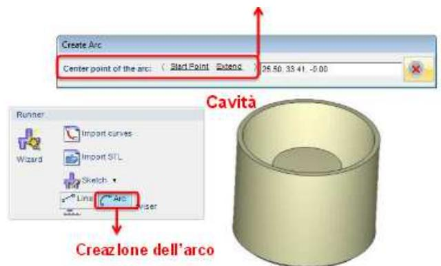
° Step 3: Dove avessimo il centro dell'arco come posizionamento ("Center Point of the Arc"), basta specificare questo punto, che solitamente, per questioni di simmetria è il centro della cavità. Per posizionarlo in modo preciso si utilizza la funzione "Show Mesh Lines".
