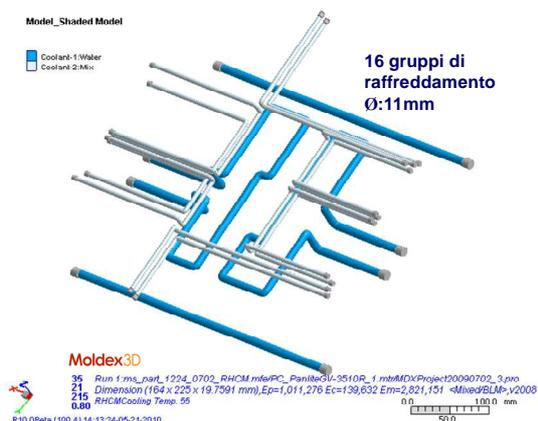
Il settaggio dei vari elementi del sistema di raffreddamento, con tecnica H&C Variotherm ha permesso di valutare diversi scenari, rispetto alla metodologia standard e di scegliere quello che si riteneva migliore.
