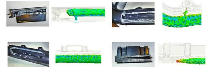
Riassumendo il pacchetto GAIM fornisce un'analisi accurata di tutte le interazioni che avvengono tra plastica e gas in fase di riempimento, fornendo un pannello di parametri di controllo esaustivo.
