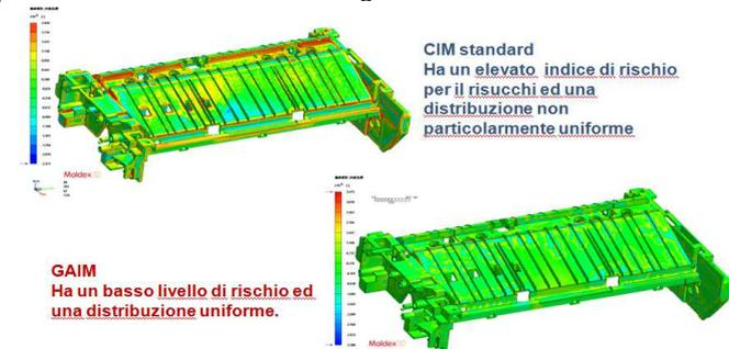
Su un particolare come quello indicato sopra, procedendo con un metodo CIM standard, il livello di rischi di avere profondi risucchi (presenza di frequenti nervature e cambio spessore) è elevato, così come la distribuzione stessa dei risucchi è quantomodo non uniforme.
