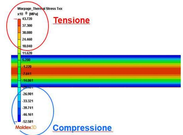
Esso può essere generato dall'alta velocità di scorrimento del flusso della plastica durante l'operazione di riempimento della cavità, piuttosto che dal rilascio e/o stabilizzazione (frozen phase) nelle fasi post-riempimento o dopo l'apertura dello stampo.
