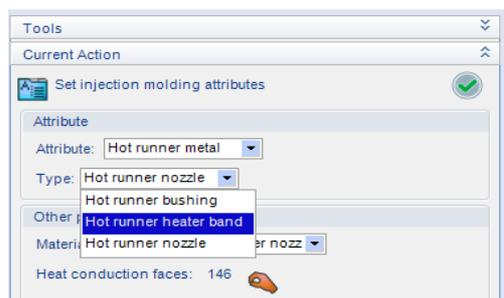
La struttura della camera è definita all'interno di Moldex3D eDesign come entità propria, con le proprie caratteristiche (componente di metallo caldo del runner, ugello a canale caldo, boccola canale caldo e caldo banda riscaldamento del runner).
