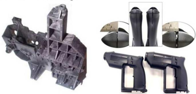
Lo stampaggio ad iniezione **MuCell®** comporta un impiego altamente controllato di gas allo stato supercritico (SCF) che crea bolle di vuoto infinitesimali (micron), permettendo di operare con pezzi stampati in presenza di pareti sottili (meno di 3 mm).
