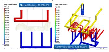
Il tempo di ciclo è anche un problema importante di cui si deve tener conto nella progettazione del sistema di raffreddamento . Rispetto al progetto convenzionale, il raffreddamento conformato può ridurre il tempo di ciclo di 10 sec , (circa il 33 % del ciclo standard), mantenendo la stessa qualità del prodotto.
