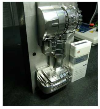
Questo studio si propone di confrontare l'efficienza e la bontà di un sistema di raffreddamento conformato, rispetto ad un progetto che utilizza un sistema di raffreddamento standard. Come mostrato nella figura sopra, questo modello ha una geometria molto complessa. Inoltre, il modello contiene froti variazioni di spessore, che inducono a forti gradienti di dispersione o contenimento della temperatura del pezzo stampato.
