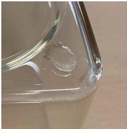
Figura 3 Difetto osservato in corrispondenza del punto di contatto con gli estrattori.
